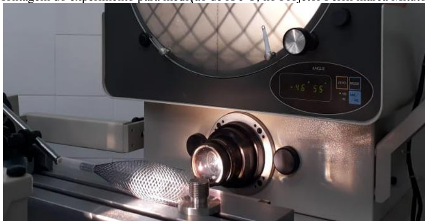
Figura 2 - Montagem do experimento para medição de X e Y, no Projetor Perfil marca Mitutoyo PJ-A3000
