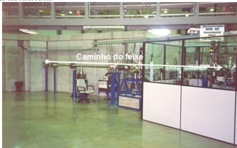
Figura 4 - Foto da tubulação do anel para a linha DO9B – XRF do Laboratório Nacional de Luz Síncrotron, por onde passa o feixe de luz síncrotron.
