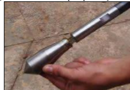
Figura 2. Ponta do DPL para penetração no solo.
