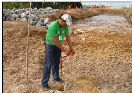
Figura 9. Preparação para execução do ensaio “vane-test”.
