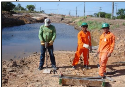
Figura 8. Execução de ensaio DPL.
