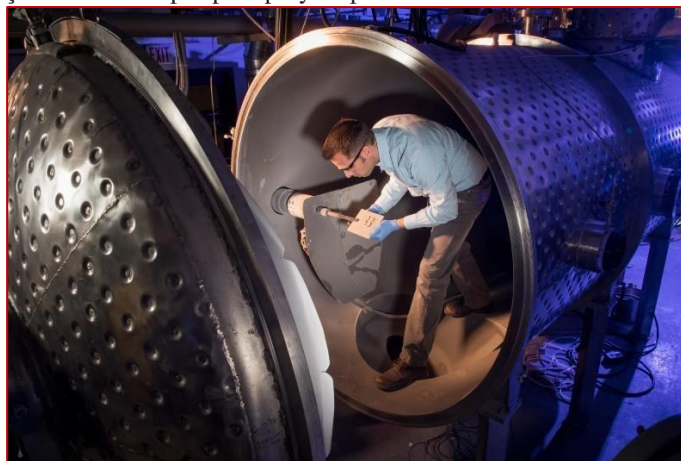
3 O engenheiro de pesquisa de materiais Bryan Harder examina revestimentos depositados em peças de carboneto de silício na plataforma de deposição física de vapor por spray de plasma na NASA Glenn. NASA, 2015.
