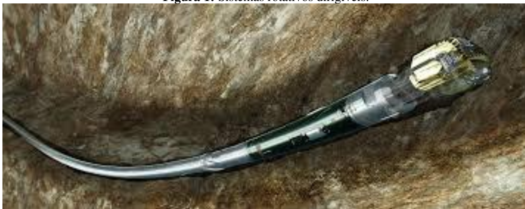
Figura 1: Sistemas rotativos dirigíveis.
