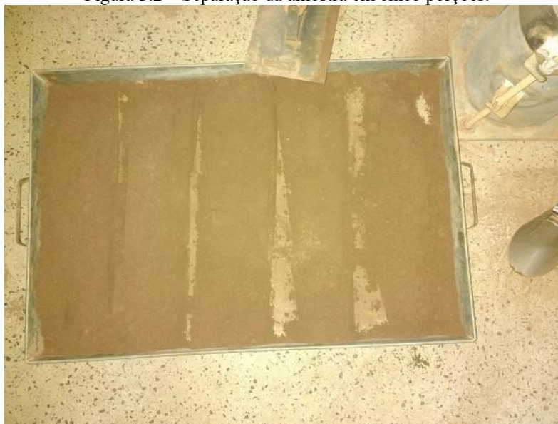
Figura 3.2 – Separação da amostra em cinco porções.
