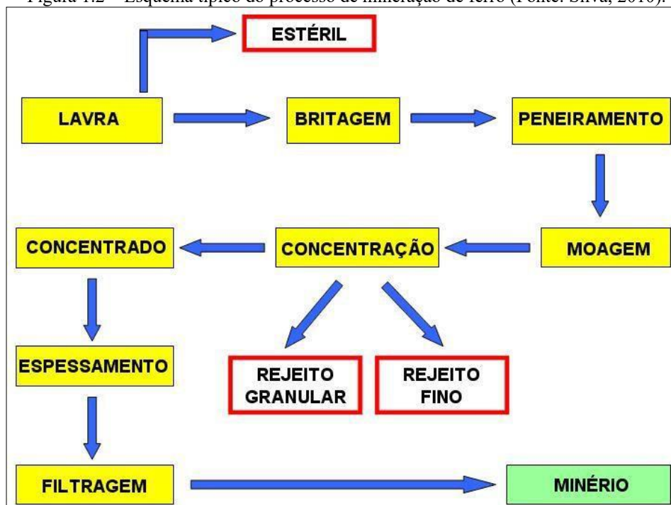
Figura 1.2 – Esquema típico do processo de mineração de ferro (Fonte: Silva, 2010).
