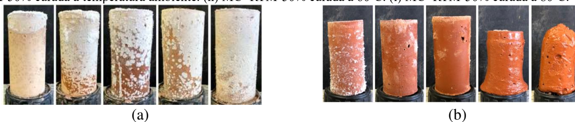
Figura 3 - Argamassas ativadas com cinco concentrações: 6, 8, 10, 12,5 e 15 mol/litro, da esquerda para a direita, respectivamente. (a) MC-100% curada à temperatura ambiente. (b) MC-100% curada a 60°C. (c) MC-100% curada a 80°C. (d) RTM-100% curada à temperatura ambiente. (e) RTM-100% curada a 60°C. (f) RTM-100% curada a 80°C. (g) MC+RTM-50% curada à temperatura ambiente. (h) MC+RTM-50% curada a 60°C. (i) MC+RTM-50% curada a 80°C.
