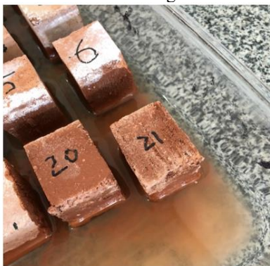
Figura 9 - Perda de massa das argamassas à base de RTM.
