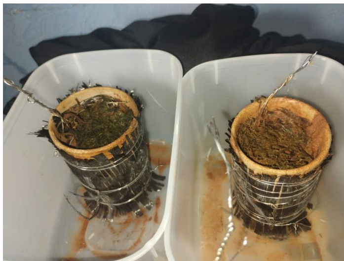
Figura 17 - BCMs da esquerda para direita, camada difusora de gás convencional, camada difusora de gás com catalizador de hidrogel Fe-N-C
