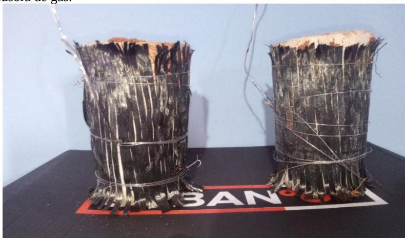
Figura 8 - Cátodo já inserido nas BCMs, da esquerda para direita: camada difusora de gás e catalizador de hidrogel Fe-N-C incorporado a camada difusora de gás.
