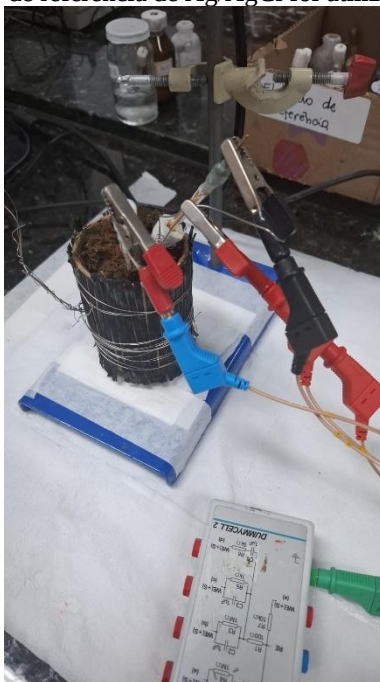
Figura 10 – Experimentos em meia célula para célula eletroquímica desenvolvida. O ânodo como eletrodo de trabalho, uma placa de platina como contra eletrodo e um eletrodo de referência de Ag/AgCl foi utilizado para as medidas de potencial.
