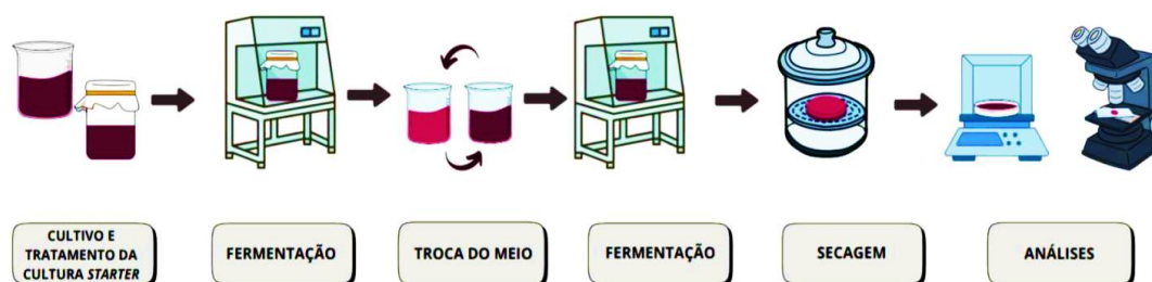
Figura 1 – Fluxograma apresentando as etapas da produção do biofilme / Scoby a partir da E. oleracea .
