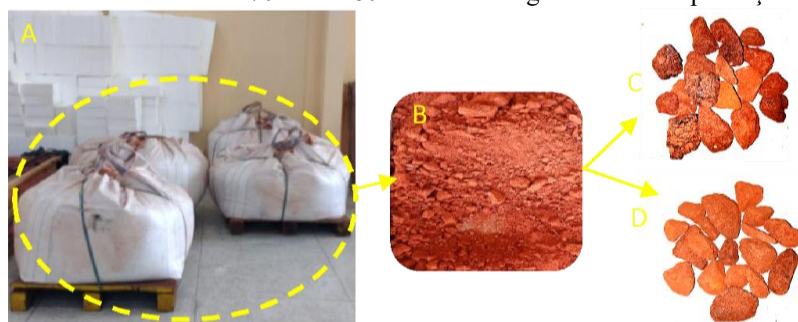
Figura 2 - Armazenamento do resíduo de bauxita no laboratório de Engenharia Civil da UFPA. A) Disposição da forma que o material foi transportado e posteriormente armazenado; B) Aspecto do Resíduo in natura; C) e D) Amostras do AGS70 e AGS80 obtidos no segundo ciclo de produção.
