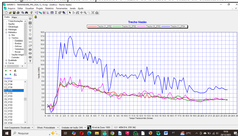
Figura 14. Série temporal da capacidade e vazão de trechos do canal da Tamandaré.
