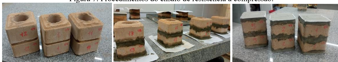
(A) Cortes dos tijolos
