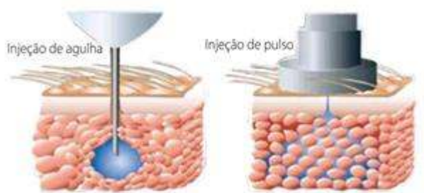
Figura 6 - Espalhamento cônico da solução aplicada pelo sistema de injeção sem agulhas em comparação com o sistema de entrega tradicional.
