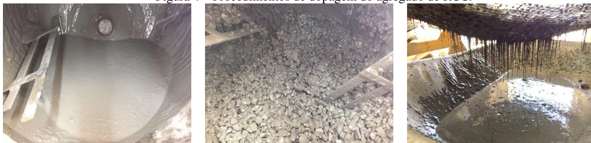
Figura 4 – Procedimentos de dopagem do agregado de RCC.
