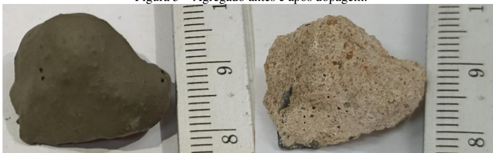
Figura 5 – Agregado antes e após dopagem.
