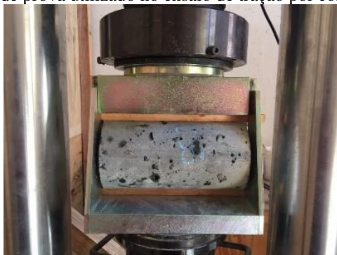
Figura 10 - Corpo de prova utilizado no ensaio de tração por compressão diametral.
