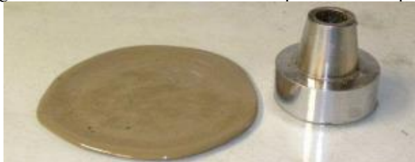
Figura 3 - Ensaio de mini abatimento: espalhamento da pasta.
