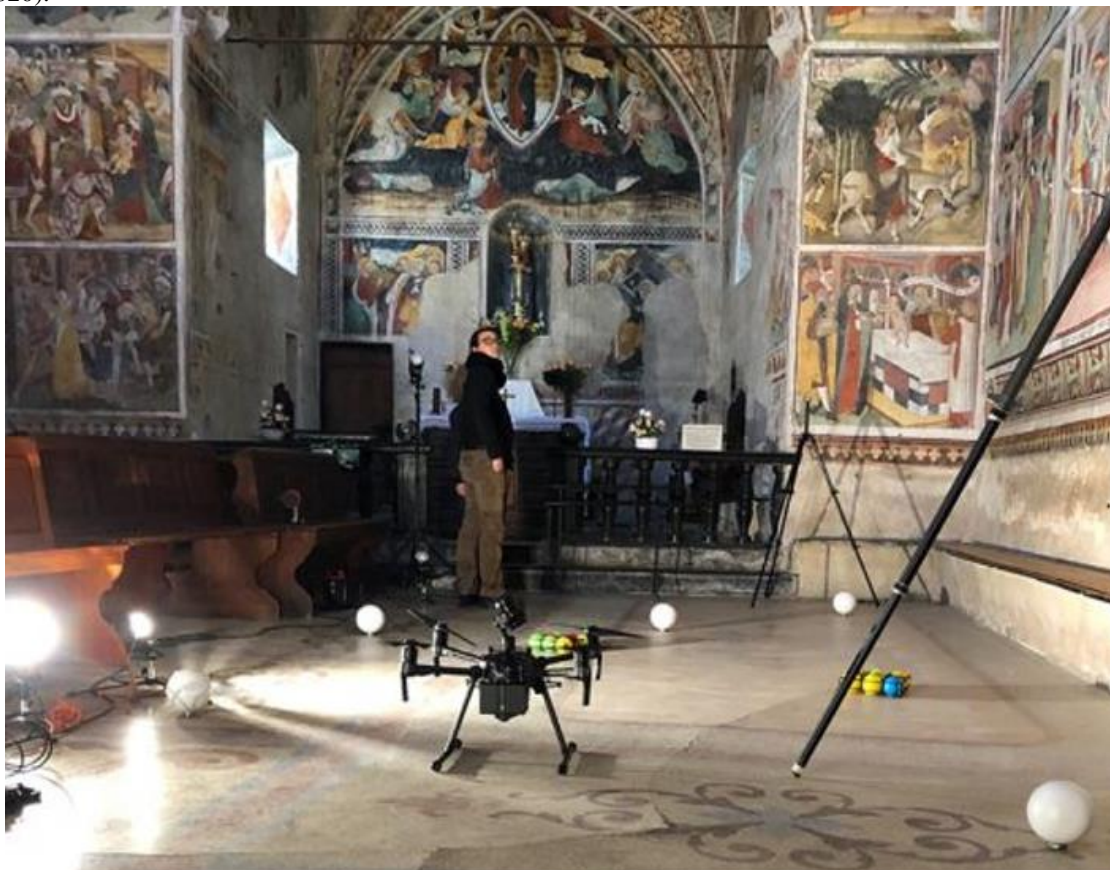
Figura 1 – Levantamento de pintura mural com ortofotogrametria e auxílio de drone. (Fonte: UMR 3495 CNRS / MC MAP, 2020).
