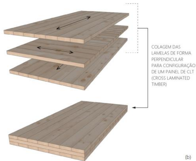
Figura 1– Configuração do painel de CLT
