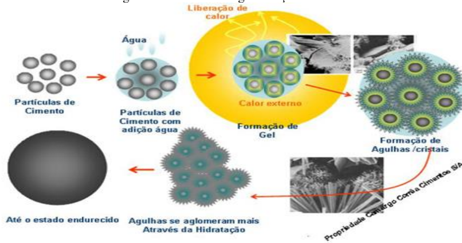
Figura 1 - Processo de aglomeração do cimento
