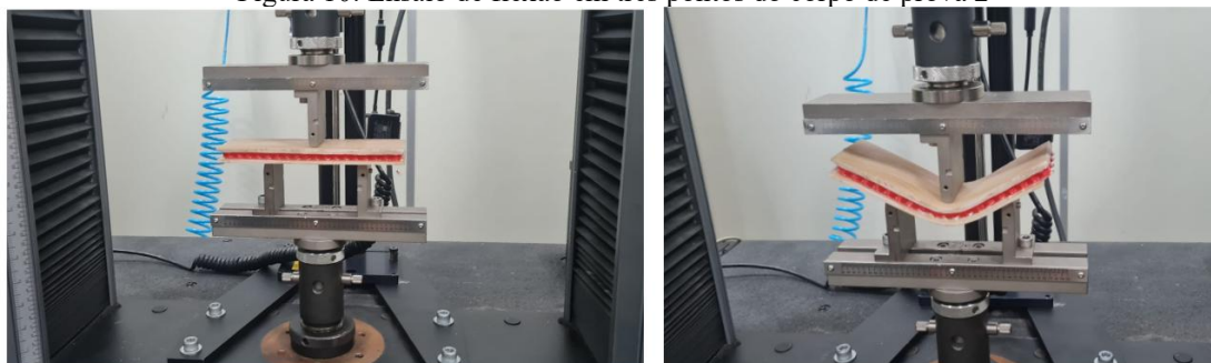
Figura 10: Ensaio de flexão em três pontos do corpo de prova 2
