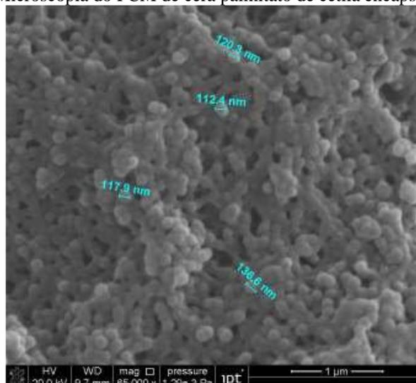
Imagem microscópica de MEV do PCM da cera palmitato de cetila produzido utilizando monômero funcional HEMA, obtida com aumento de 65 000 x.
