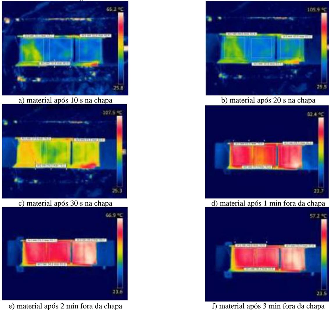
Comportamento térmico comparativo de um tecido plano sem nenhuma aplicação (à esquerda), um tecido plano contendo apenas a resina (central) e um tecido contendo PCM de manteiga de ucuúba (à direita).
