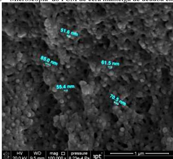
Imagem microscópica de MEV do PCM da cera manteiga de ucuúba produzido utilizando monômero funcional HEMA, com aumento de 100.000 vezes.
